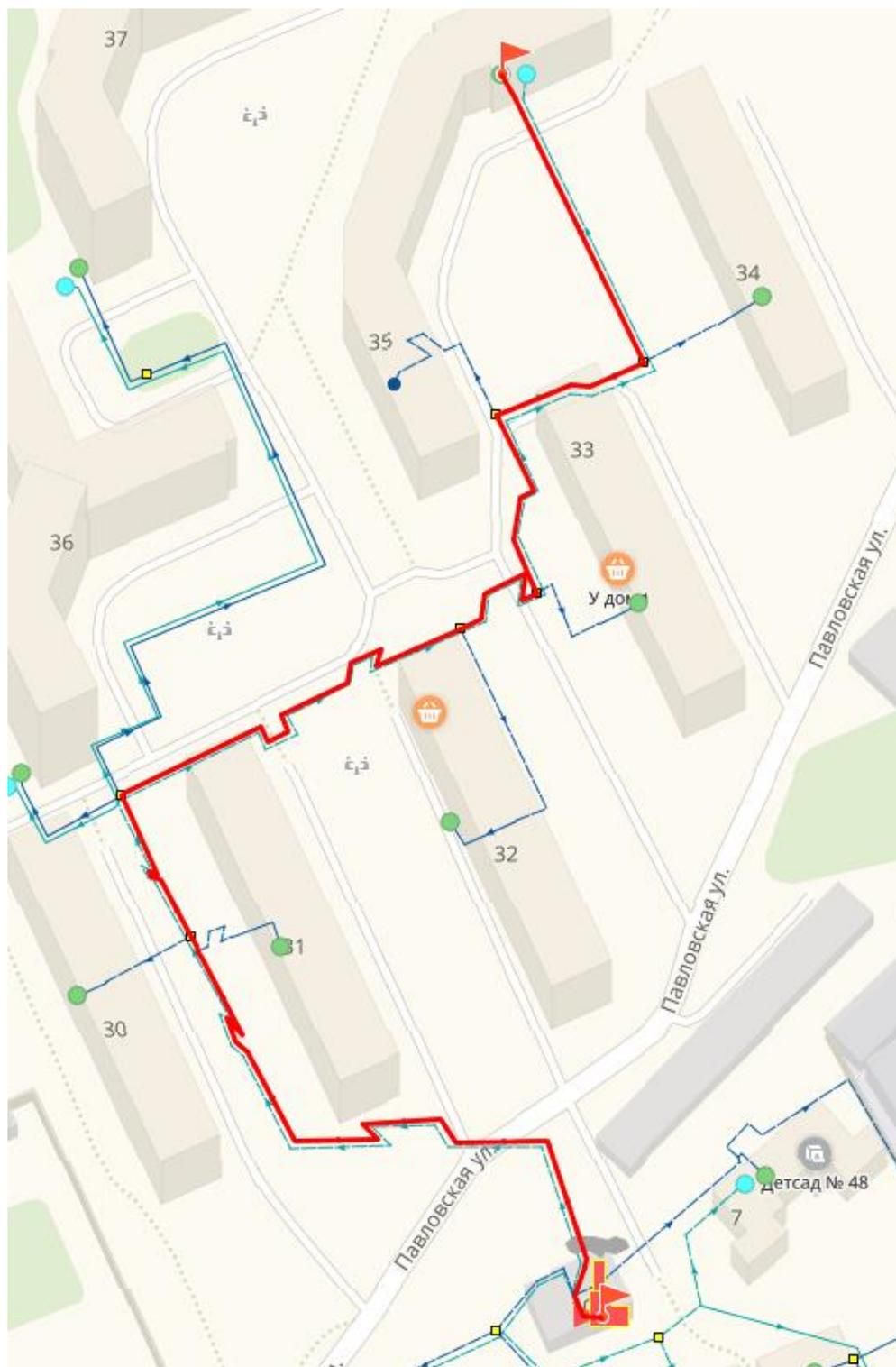
Рисунок 2.27 – Трассировка теплопровода от котельной МУП «РМПТС» (пос. Мехзавода, 10 стр.1) до конечного потребителя «ИТП-Мехзавод,35» (расчетный путь 10-1)
