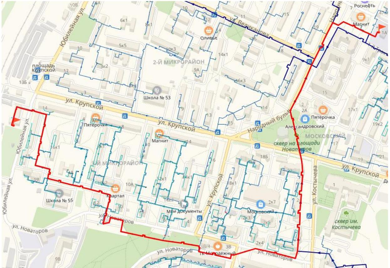
Рисунок 2.21 – Трассировка теплопровода от котельной №1 МУП «РМПТС» (1-й Тракторный пр., 14 лит. А) до потребителя «ИТП-Юбилейная,15а» (расчетный путь 6-1)
