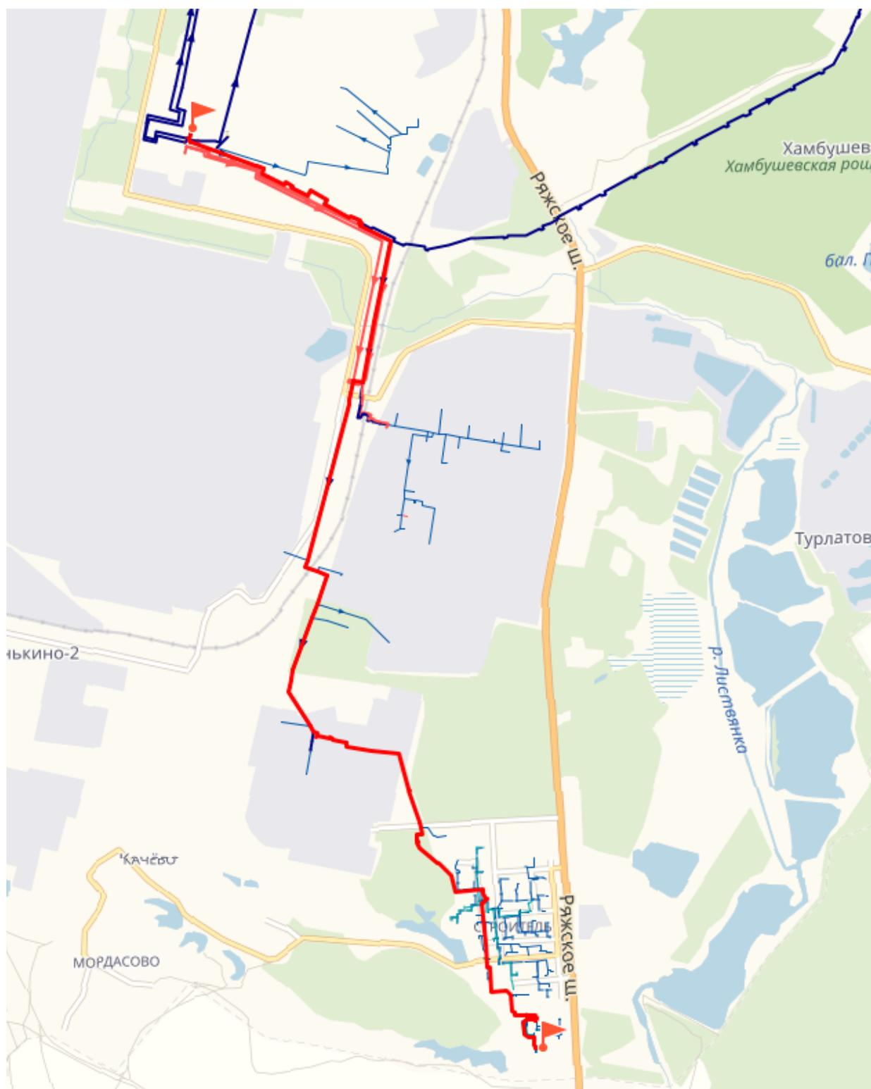
Рисунок 2.13 – Трассировка теплопровода от Ново-Рязанской ТЭЦ до потребителя «ИТП-Качевская,36к1» (расчетный путь 2-5)
